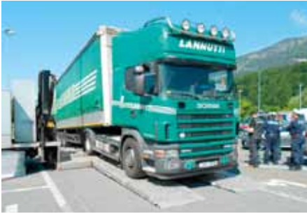
Kontrolle eines LKWs auf dem mobilen Bremsenprüfstand
